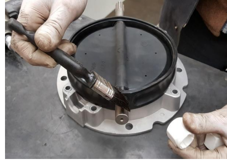
2- Mil uçlarına yağ sürünüz. 2- Apply oil to the two sides of disc's shaft.
