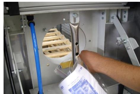
Fan çıkış ağızı ortama göre uygun yöne çevrilir ve fan üzerinde bulunan civatalar flansa somun ile sıkılır. Fan montajı tamamlanır. Fan takılmış filtrenin kapağı açılırken dikkat edilmelidir. Fan ağırlığı serbest haldeki filtreyi arkaya doğru devirebilir.
