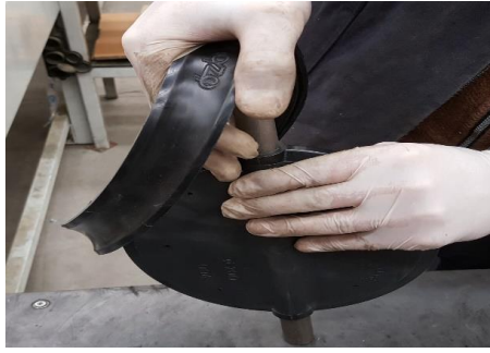
1- Klepe diskinin her iki ucuna contayı takınız. 1- Fit the seal on the two sides of disc.
