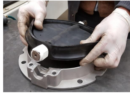
4- Diski klepe alt flanşına yerleştiriniz. 4- Fit the disc on the lower body of valve.
