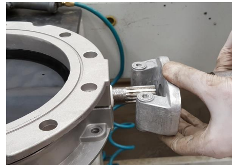
6- Mil ucuna aktüatör bağlantı takozunu yerleştiriniz. 6- Fit the support bracket.
